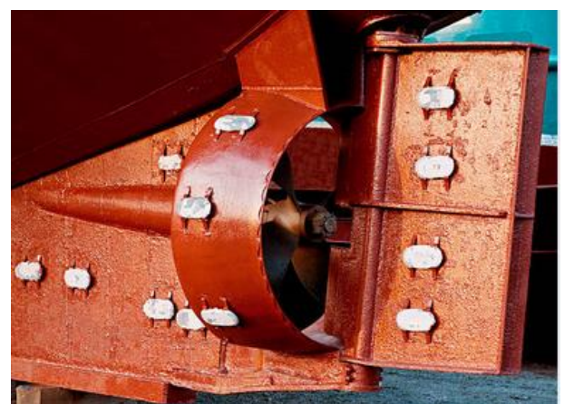
Anodes de zinc sur la coque d'un navire
